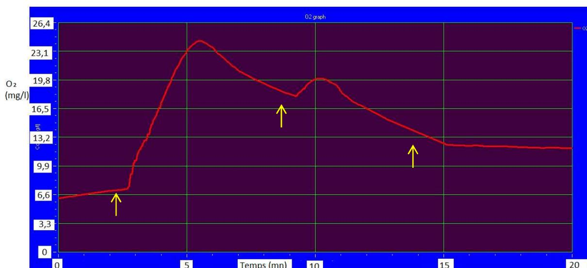
Figure 50 :  $[O_2] = f(t)$  après 3 injections successives de 0,5 % d' $H_2O_2$  sur bille d'alginate immobilisée au contact d'une électrode de Clark
