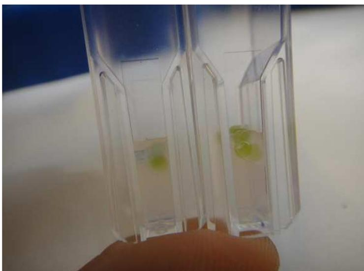
Figure 32 : billes d'alginate dans une matrice sol-gel
