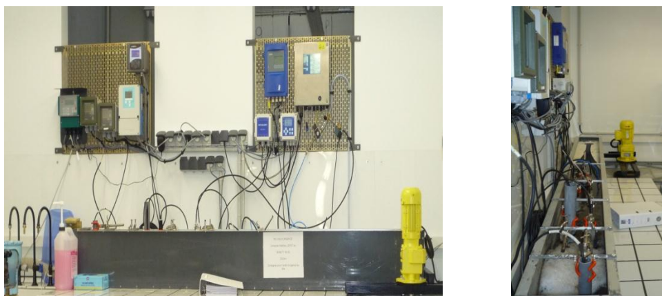
Figure 20. Banc d'essai de capteurs de suivi de la qualité des effluents
