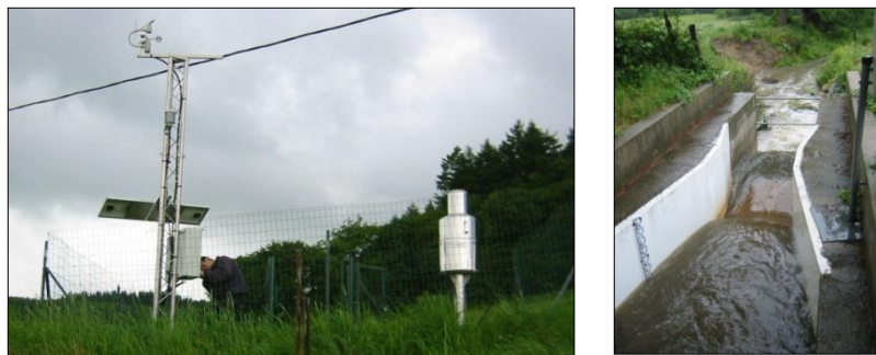
Figure14. La station météo de Montromant (Yzeron) et le canal Parshall de la station de la Léchère
